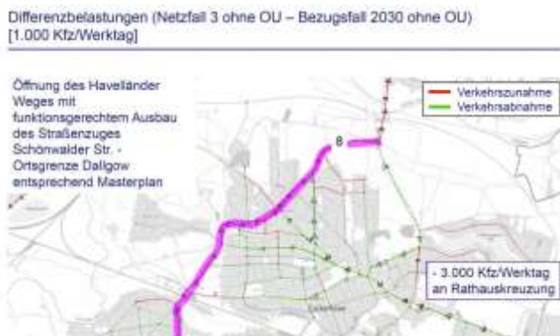
Abbildung: Verkehrsmodell der IVV: Für 2030 werden im Havelländer Weg 8.000 Kfz pro Tag erwartet.
